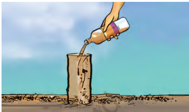
चित्र 9.5 अंतःस्त्रवण दर को मापना
